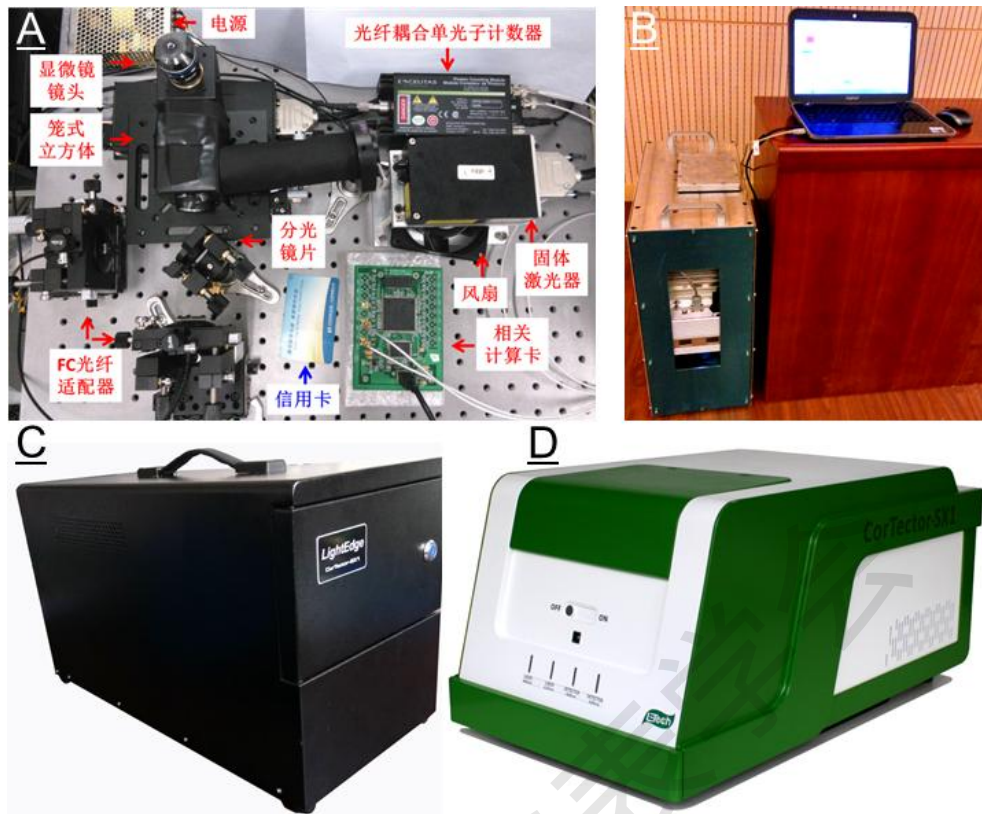
图3 桌面式荧光相关光谱仪的研制。(A) 第一代用于原理验证的实验室样机。(B) 第二代工程样机。(C) 第三代工程样机。(D) 第四代工程样机(即第一代商业仪器:CorTector™SX)。
