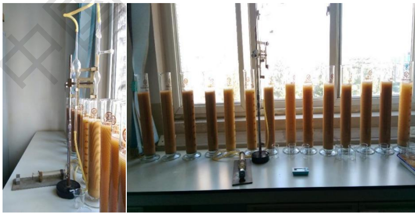
图 1. 传统沉降法所用自制玻璃装置
