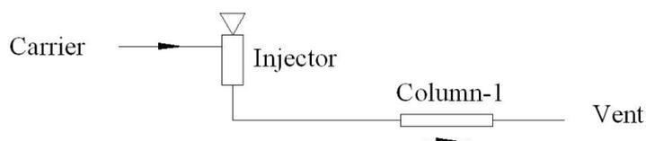
图 2 进样状态下系统结构简化示意图
