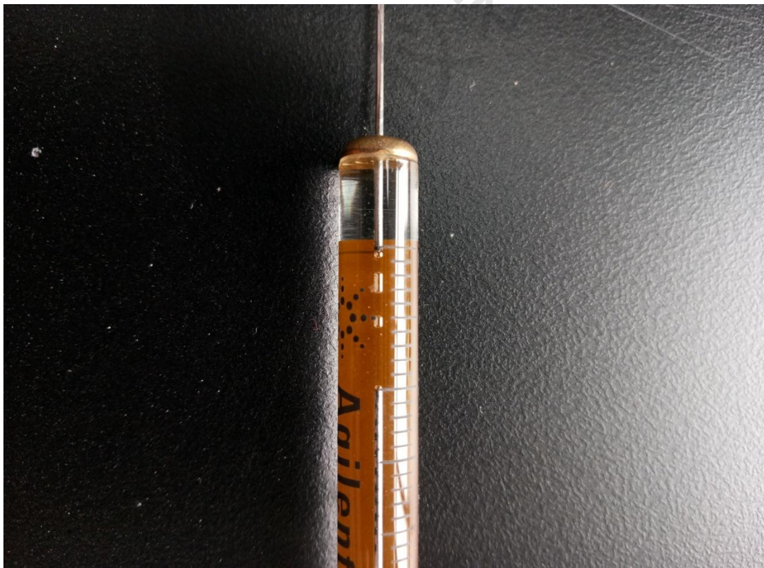
图6 三明治进样法进样针取样情况
