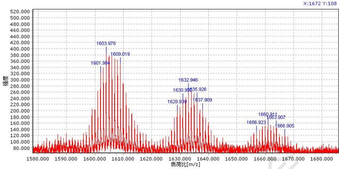
样品编号: wlj100; 分子式:  $[(C_7H_7)_2Pd_3]_2(C_3H_4N_4)_3(BF_4)_7$ ; 样品浓度: 20ppm; 分子量: 3241.74465
