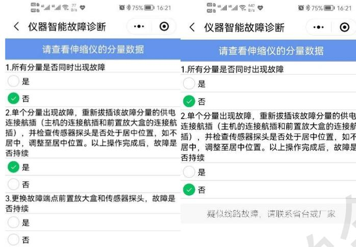
图 12 诊断单分量故障的界面实现
