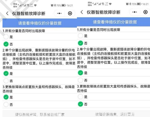
图 13 诊断标定装置故障的界面实现
