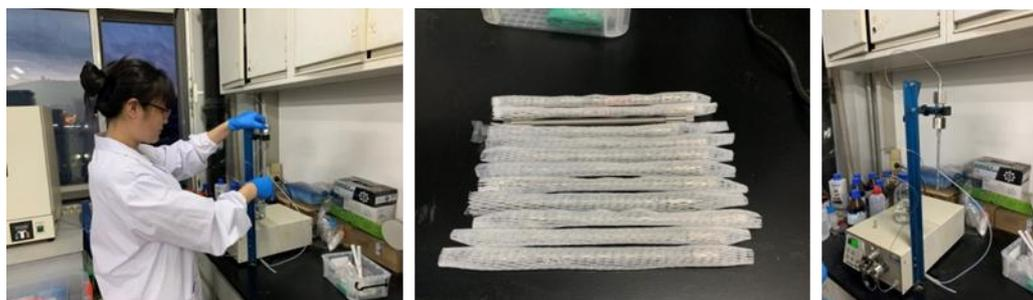
图 4 氯酚印迹聚合物材料为固定相超高效液相色谱柱的制备过程
