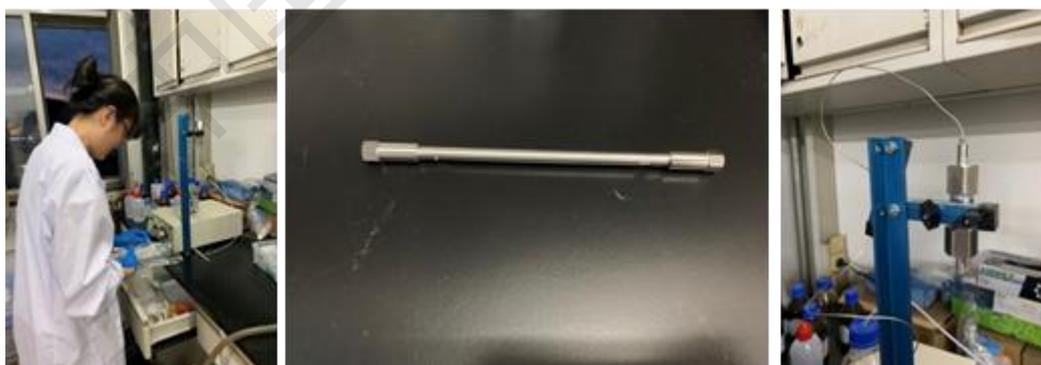
图 5 三嗪类莠去津印迹聚合物材料为固定相超高效液相色谱柱的制备过程
