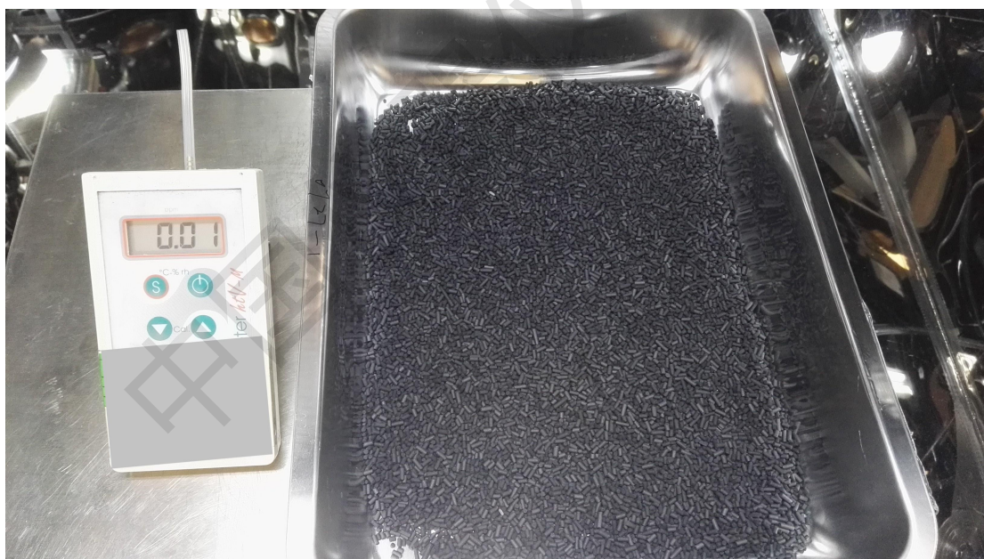
1.4.1 将 PPM 甲醛检测仪放入 3 立方测试舱内，测得舱体本底 0.01ppm，
