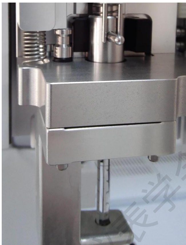
图3 进样针安装正常状态
