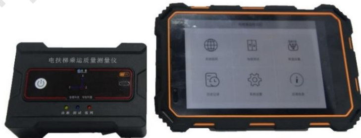
图 3 电/扶梯乘运质量综合测量仪
