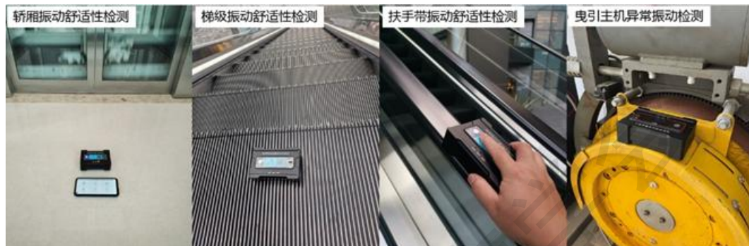
图 4 垂直电梯/自动扶梯不同测试模式下仪器使用照片
