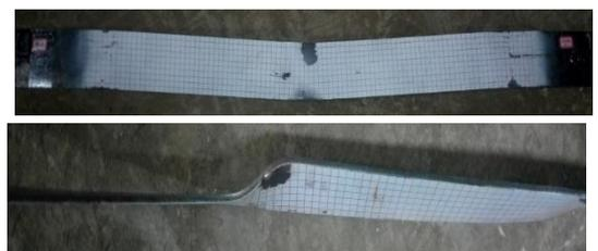
图9 试验后的试件（冲击速度 4.5 m/s）
