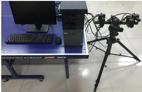
图 1 DIC 非接触式应变光学测量系统
