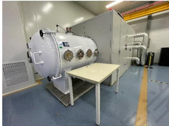
图 1 1m 真空环境模拟试验装置
