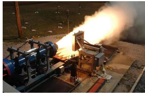
图 2 压力扫描阀应用于固体冲压发动机外场试验
