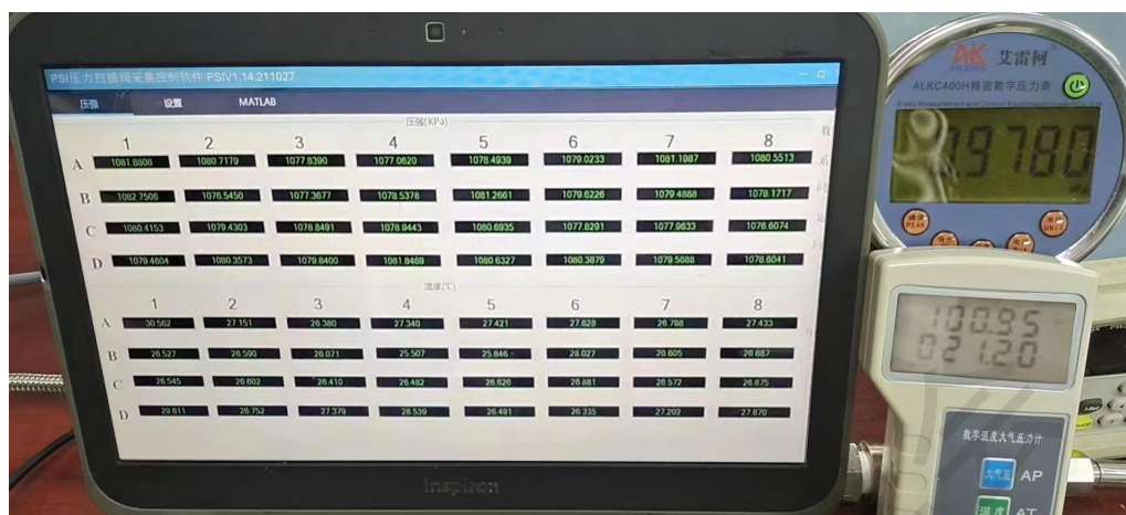
图 18 基于神经网络法温度补偿在线实验
