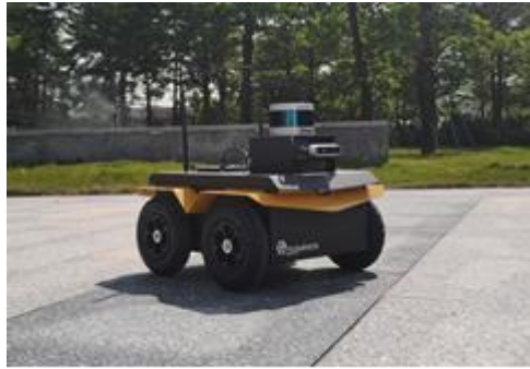
图2 Clearpath Jackal 无人车系统
