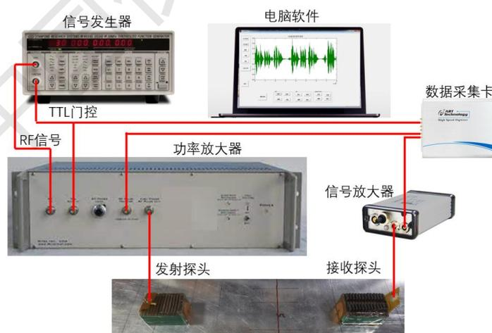
图 5 电磁超声导波检测系统组成
