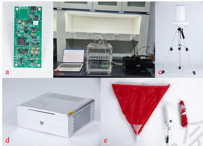
图 13 传感器测试系统及原位感知系统实物图；a. 传感器后端数据采集系统；b. 传感器测试系统；c. 天线； d. 接收机；e. 探空仪。
