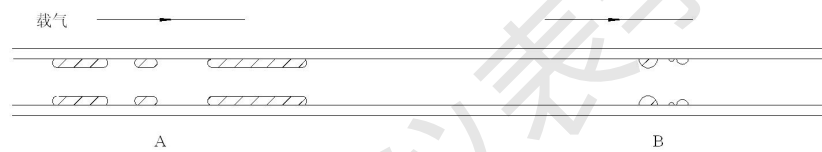
图4 溶剂不良时色谱柱内样品的分布状态
