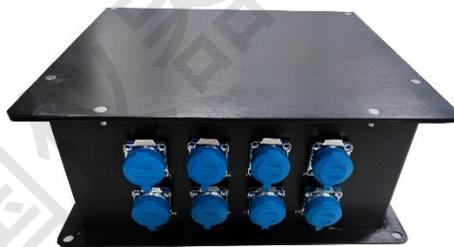
图 13 超声导波监测系统主机
