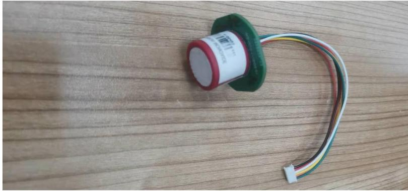
图 3-5 自研气体检测模块实物图
