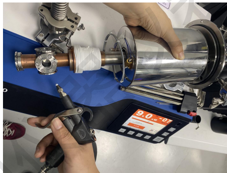
图3 氦气真空仪检测恒温器内窗漏率
