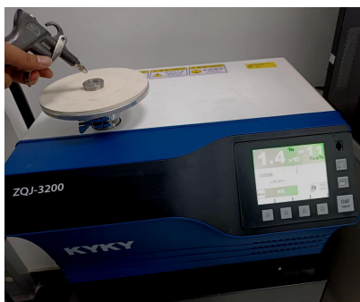
图8 氦气真空仪检测真空法兰套组加工件漏率
