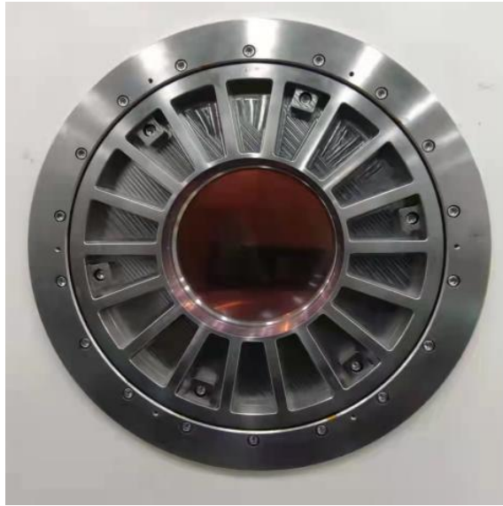
图 5 直径 330mm 光学玻璃窗口安装照片
