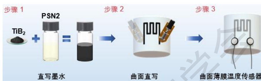
图 3 曲面薄膜温度传感器制备流程
