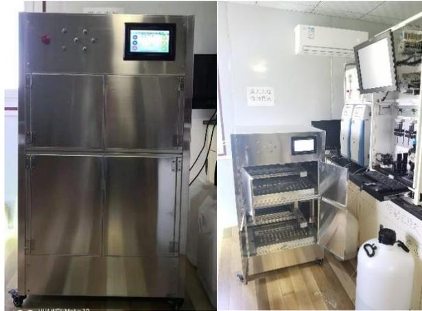
图 6 系统整机实物及其与 IGAC S-611 在线离子色谱联机图
