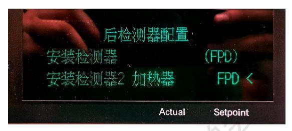
按照 7890 更换 FPD 接口板的操作要求需要在控制面板的配置里把原来的检测器移除后又重新(安装)配置回来。上图就是重新配置时的选项(默认光标在第一行选项)。回忆当时由于快速操作,没有多想就选择了第一项。(也怪该死的中文菜单翻译,如果看到的是"install Det with A2 heater FPD"我肯定不会手快搞错了,埋了个坑给自己。)到此,熟悉安捷伦气相或者有过相关经验的工程师应该就知道是什么问题了。稍后将在结论中详细解释。
