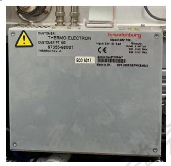
(3) 再次上门将修复的打拿极电源换上后,报错消失,调谐正常。经客户一段时间做样测试都没问题,维修结束。
