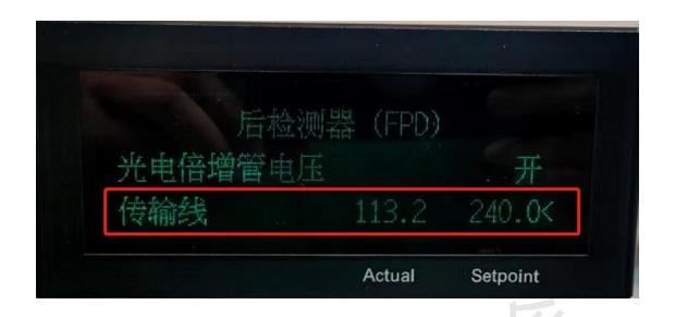
2 安捷伦气质质 G7000B 报错"2.3 MS1 加热器控制器无法在指定的时间之后调节请求的设置"
