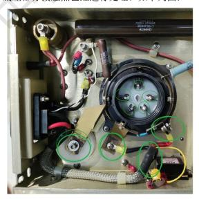
图中绿色部分标记的接触点,都已经用锉刀或者砂纸打磨抛光。
