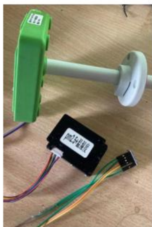
图 2 传感器系统为温湿度 PM2.5、气压、风速三大传感器的集成
