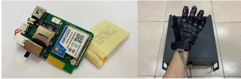
图 3-11 硬件采集装置及康复机械手实物图
