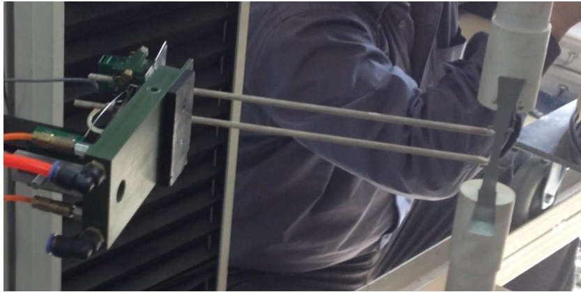
图5 超高温有氧环境下接触式变形测量装置
