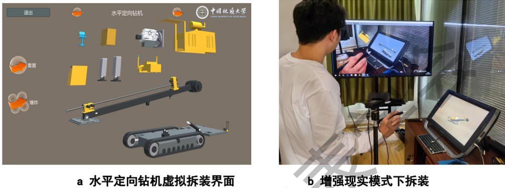
图2 基于 zSpace 的水平定向钻机虚拟拆装系统
