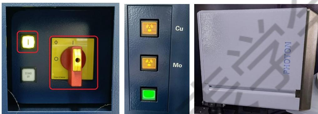
图 2 a 主切断开关；b 高压发生器按钮；c PHOTON 灯
