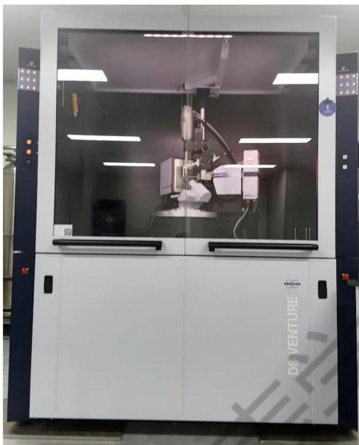
图 1 X 射线单晶衍射仪 Bruker D8 Venture
