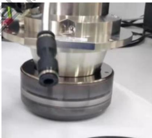
图6 表面污染的铜转靶图
