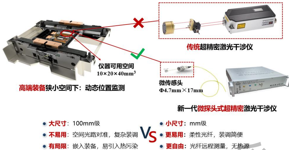
图1 微探头激光干涉仪与传统干涉仪对比
