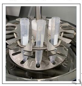
1.5 使用 1/8 铜管将氮气气源连接氮吹仪流量计进气口处,出气口处用硅胶管连接到气体分配盘处。打开 氮气阀门,氮气压力不得大于 200 kPa,调节流量计气体流量,对于不同样品管,调节不同流量,空吹氮气 5-10min,以防氮吹仪气路中残留杂质气体影响测试。
