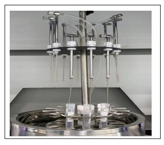
1.7 调节独立气路控制阀,使气流在样品表面产生波纹,但应防止样品飞溅。
