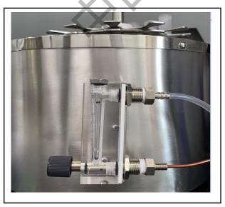
1.6 松开针头尼龙接口降低针阀导气管高度,针头距离样品液面约 6mm 处,锁紧针阀尼龙接头,固定针阀导气管。
