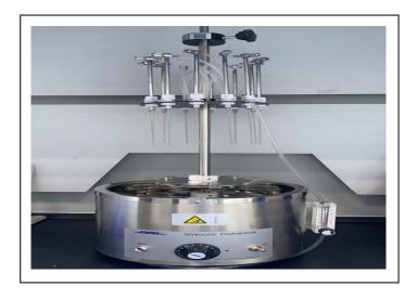
1.4 将样品试管放置到样品架上,用样品架弹簧固定好试管,试管底部处于样品底板上。
