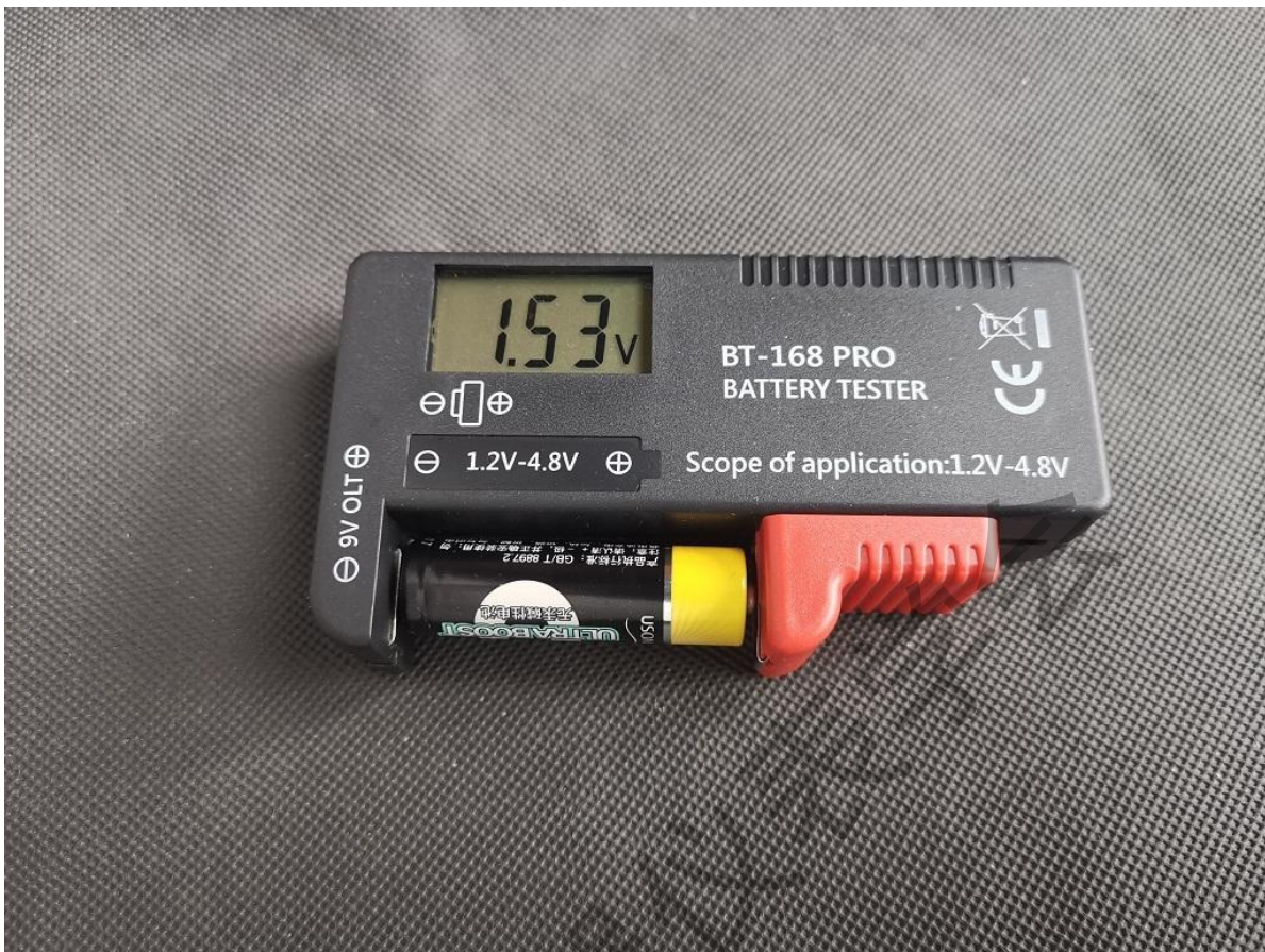
仪器侧面的两检测触点，用于检测 6F22/9V 叠层电池的电压情况：
