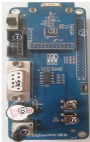
注：①JTAG 下载口；②通信接口；③CC2530； ④LED；⑤复位键；⑥用户按键；⑦ADC 输入； ⑧蜂鸣器；⑨RS232 接口。
