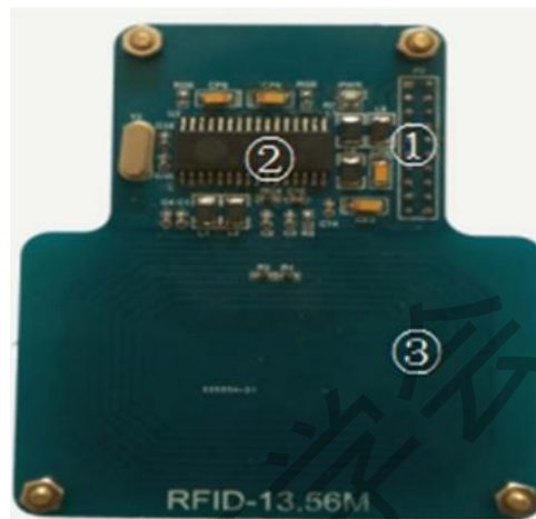
注：①通信接口；②FM1702；③读卡天线
