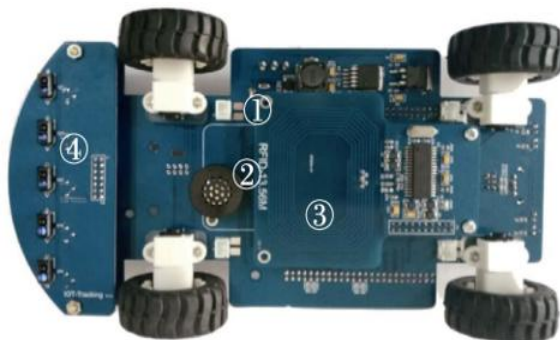
注：①电机接口；②喇叭；③RFID 读卡天线；④循迹传感器。
