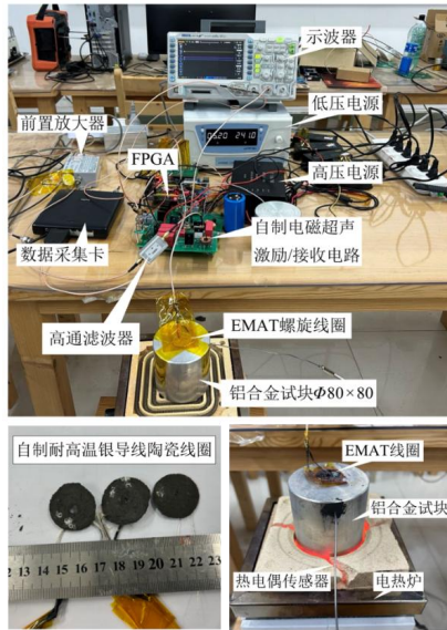
图1 高温仅线圈式 EMAT 检测系统
