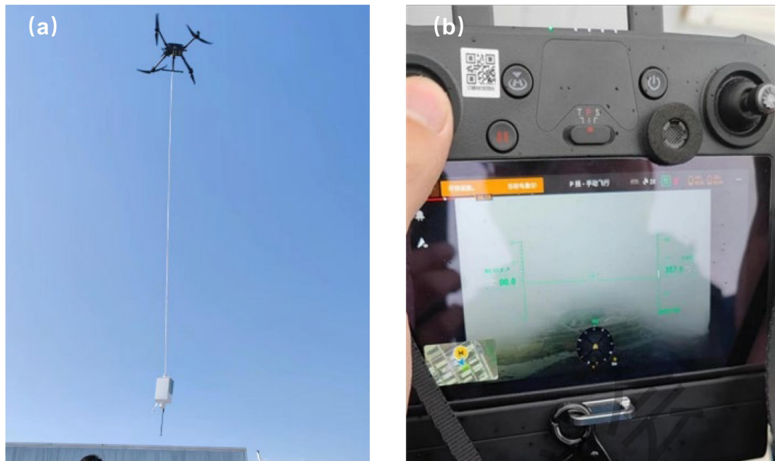
图 13 无人机穿云探测试验。(a) 无人机挂载 I-CPS 升空场景, (b) 无人机操控设备上显示的穿云场景。
