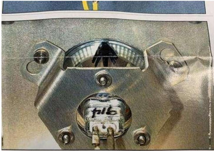
图1 灯安装方向指示图
