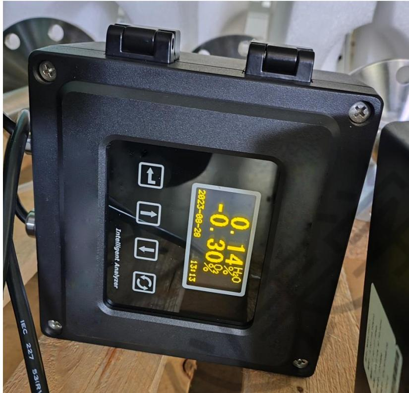
上海昶艾电子科技有限公司是一家专业做环境检测仪器的公司，产品有湿度仪，测氧仪等。我们使用的这款湿度、氧气分析仪是 CI-PC168 湿氧分析仪。该仪器采用的是传感器测量法，可同时测量环境空气、烟气中湿度和氧气含量，其中多数是用于污染源烟气排放检测的。有探杆，可以安装在烟道上，传感器在探杆前端，测量时是直接插入烟道中的。量程可以设置，湿度的量程最大可设置 0-40.00% H<sub>2</sub>O，氧气的量程最大可设置 -1-27.5 %O<sub>2</sub>。我们用它测氧气的时候较多，像环境空气中氧气大多时候都是 20.5%-21%，量程其实设到 19%-23% 足够。烟气中氧气一般会低于环境空气（烟气一般都是炼钢厂、发电厂、垃圾焚烧厂、水泥厂、热力厂等燃料燃烧排放的废气，燃料燃烧消耗掉一部分氧气），也就在 5%-20%，多数都是 10%-20%。
