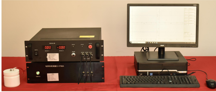
图 8 铁电测试系统实物图
