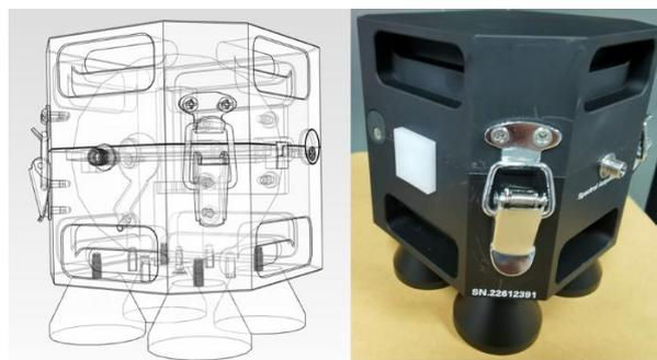
图4. 微型化积分球的实物设计图（左）和实物图（右）
