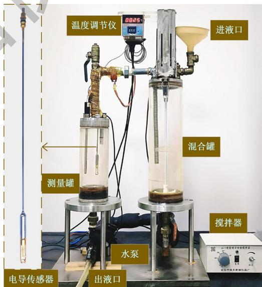
图4 持水率实验装置
