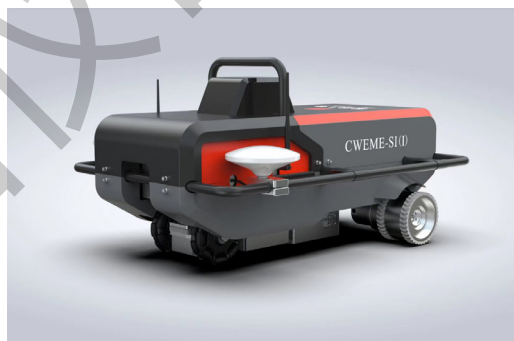
图 2 风机塔筒焊缝缺陷检测机器人
