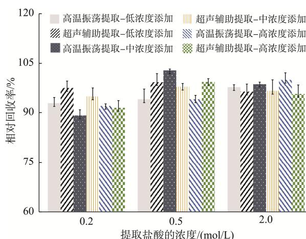
图 2 高温振荡提取与超声辅助提取在各浓度盐酸条件下对椰子基质中胭脂红酸的提取结果比较( $n=6$ )
